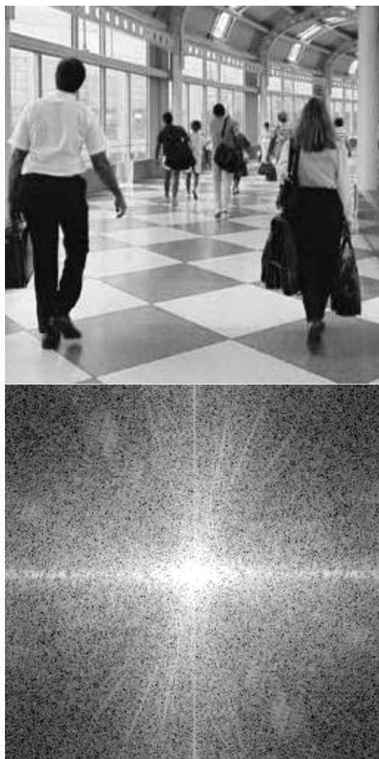
FIGURE 6.3 – Gauche : une image numérique de taille 256 \times 256 ; droite : application d'un changement de contraste logarithmique s \rightarrow C + D \log s au module de sa TFD. (Les constantes C et D sont choisies pour que l'image résultante ait ses valeurs entre 0 et 255). Le spectre décroît rapidement aux hautes fréquences (rappelons que l'image étant bornée, son spectre est dans L^2 ). C'est la grande vitesse de décroissance du spectre qui rend nécessaire l'utilisation du logarithme pour la visualisation. La symétrie centrale du module de la TFD est visible. Les lignes blanches horizontale et verticale correspondent aux bords verticaux et horizontaux de l'image, respectivement. En effet, l'image étant implicitement périodisée elle présente un contraste brusque entre bord haut et bord bas d'une part, coté droit et coté gauche d'autre part. Remarquer également les lignes obliques qui correspondent aux bords obliques de l'image (voir en particulier les dalles sur le sol).
