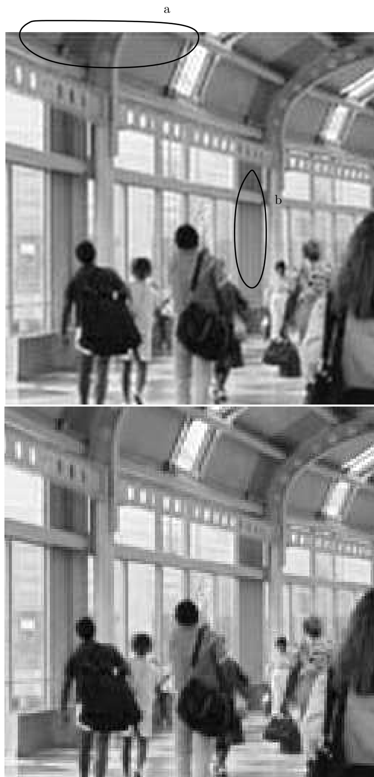
FIGURE 6.7 – Zoom sur une partie de l'image 6.3. Haut : zoom par TFD (zéro-padding), bas : zoom par réplification des pixels. Le zoom par TFD est obtenu en prolongeant par des zéros le spectre de l'image initiale. Celui par réplification des pixels en remplaçant chaque pixel par quatre pixels de la même valeur. Remarquons tout d'abord la plus grande régularité du zoom par TFD, qui supprime les effets de "blocs" très visibles sur le zoom par réplification. En contrepartie, le phénomène de Gibbs (voir paragraphe 5.4) est très visible sur le zoom par TFD, puisque l'on a mis à zéro brutalement des coefficients de la TFD. Ce phénomène est particulièrement visible le long des frontières de l'image, qui correspondent à des discontinuités puisque l'image est périodisée (par exemple zone a). On observe aussi le phénomène de Gibbs le long des contours des objets (par exemple zone b).
