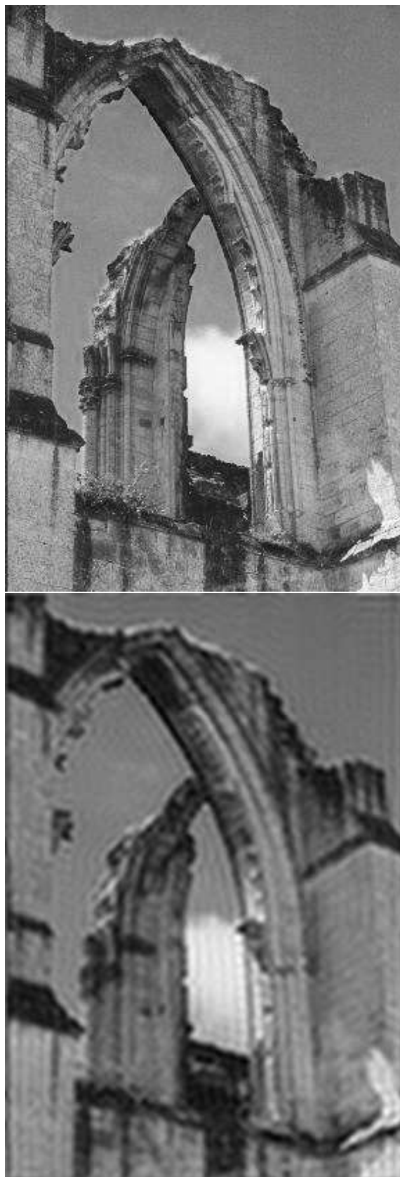
FIGURE 5.2 – Illustration de l'effet de Gibbs. Gauche : l'image originale; droite : l'image après que l'on ait tronqué ses hautes fréquences, et sur laquelle sont visibles de nombreuses oscillations. L'image de droite est obtenue en ne conservant que les fréquences dont le module est inférieur au quart de la fréquence maximale. Le phénomène est particulièrement visible le long des frontières du domaine de l'image (voir en particulier le côté droit) et le long des discontinuités de l'image. Remarquons que l'image est également devenue floue par suppression des hautes fréquences.
