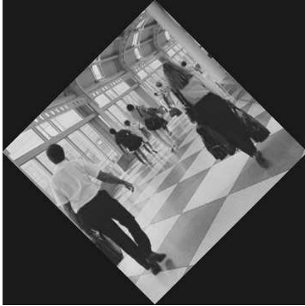
FIGURE 6.9 – Rotation de \pi/4 par TFD. La rotation est implémentée en remarquant qu'elle peut se décomposer en trois transformations consistant en des translations selon les lignes ou les colonnes de l'image (formule 6.17). Chacune de ces transformations est ensuite effectuée grâce à une TFD sur la ligne ou colonne considérée, en utilisant la méthode présentée au paragraphe précédent.
