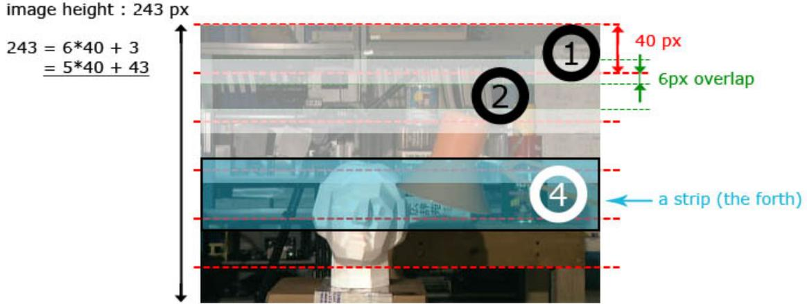
FIGURE 20 – Pour l’utilisation du code en ligne, on a découpé les images en six bandes horizontales.
