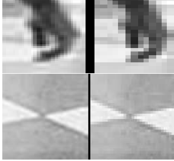
FIGURE 7.8 – détails après zoom, à gauche par TFD, à droite par réplcation des pixels.
