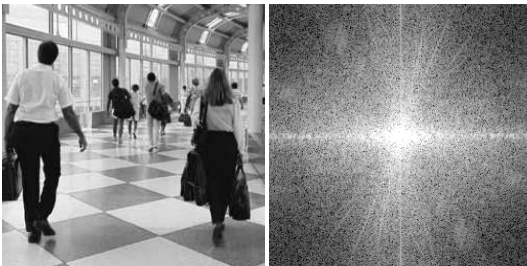
FIGURE 7.3 – Gauche : une image numérique de taille 256 \times 256 ; droite : application d'un changement de contraste logarithmique s \rightarrow C + D \log s au module de sa TFD. (Les constantes C et D sont choisies pour que l'image résultante ait ses valeurs entre 0 et 255). Le spectre décroît rapidement aux hautes fréquences (rappelons que l'image étant bornée, son spectre est dans L^2 ). C'est la grande vitesse de décroissance du spectre qui rend nécessaire l'utilisation du logarithme pour la visualisation. La symétrie centrale du module de la TFD est visible. Les lignes blanches horizontale et verticale correspondent aux bords verticaux et horizontaux de l'image, respectivement. En effet, l'image étant implicitement périodisée elle présente un contraste brusque entre bord haut et bord bas d'une part, coté droit et coté gauche d'autre part. Remarquer également les lignes obliques qui correspondent aux bords obliques de l'image (voir en particulier les dalles sur le sol).
