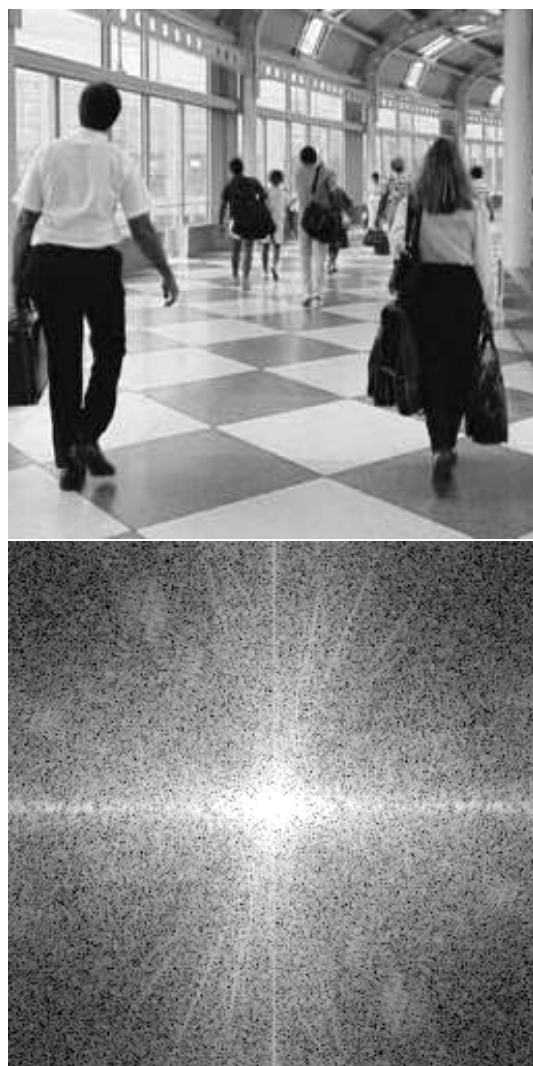
FIGURE 5.3 – Gauche : une image numérique de taille 256 \times 256 ; droite : application d'un changement de contraste logarithmique s \rightarrow C + D \log s au module de sa TFD. (Les constantes C et D sont choisies pour que l'image résultante ait ses valeurs entre 0 et 255). Le spectre décroît rapidement aux hautes fréquences (rappelons que l'image étant bornée, son spectre est dans L^2 ). C'est la grande vitesse de décroissance du spectre qui rend nécessaire l'utilisation du logarithme pour la visualisation. La symétrie centrale du module de la TFD est visible. Les lignes blanches horizontale et verticale correspondent aux bords verticaux et horizontaux de l'image, respectivement. En effet, l'image étant implicitement périodisée elle présente un contraste brusque entre bord haut et bord bas d'une part, coté droit et coté gauche d'autre part. Remarquer également les lignes obliques qui correspondent aux bords obliques de l'image (voir en particulier les dalles sur le sol).
