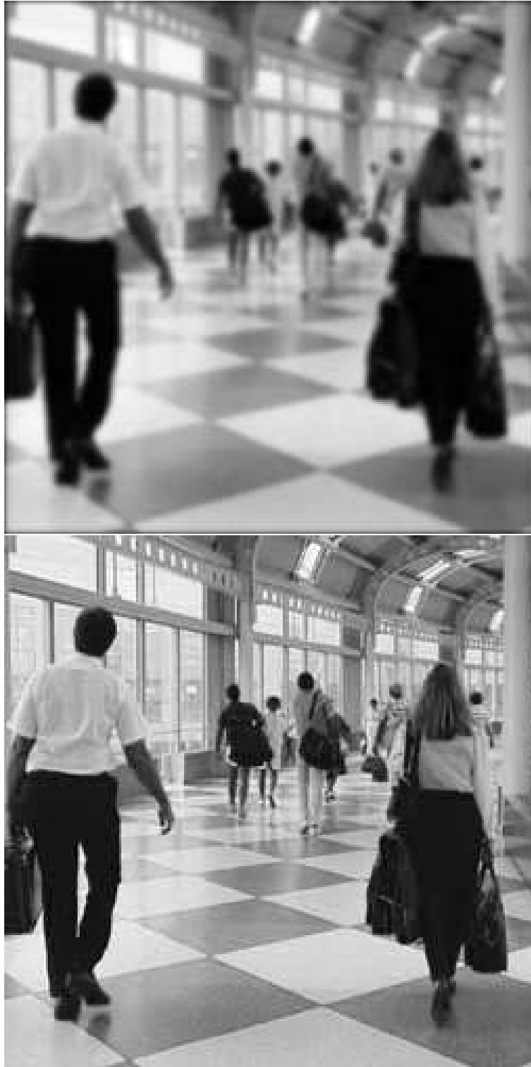
Figure 9.10: Bas: après douze rotations successives de \pi/4 par TFD; haut: même expérience en utilisant une interpolation bilinéaire (la valeur en un nouveau point (x, y) est obtenue par combinaisons linéaires des valeurs aux quatre points à coordonnées entières de l'image originale les plus proches de (x, y) ).
