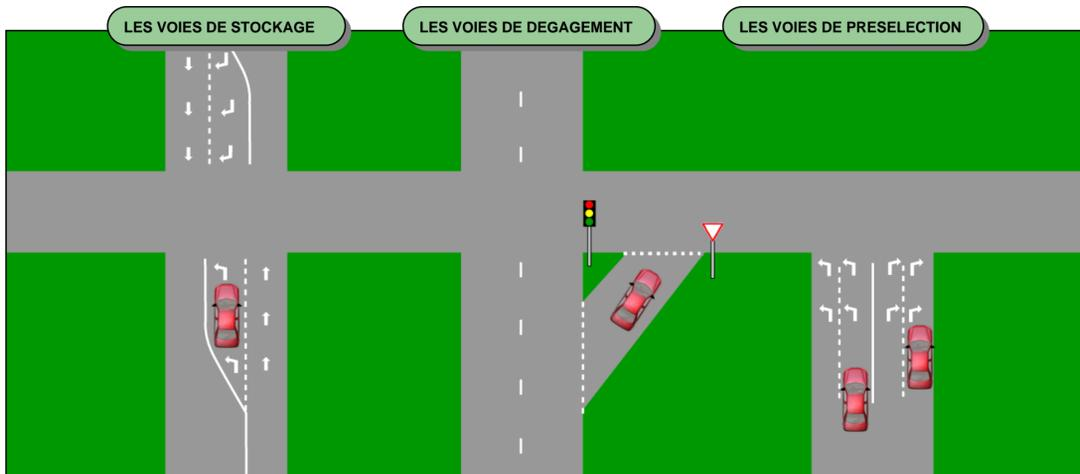
À l'approche de certains carrefours, des voies de stockage permettent de positionner les véhicules selon des directions différentes.
