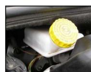
Réservoir du liquide de freinage.
