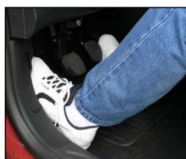
Au repos, le pied se trouve placé à gauche à côté de la pédale d'embrayage.
