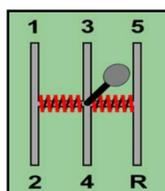
Avant la mise en route du moteur, vérifiez que le levier de vitesse est bien au point mort.
