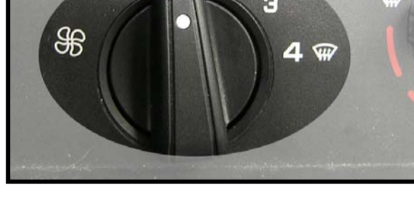
COMMANDE DU VENTILATEUR
