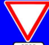
Stop à 150 m (signal avancé)
